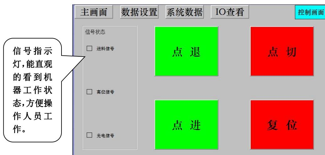
5.1 **主画面** 按钮，使用返回按钮可以将显示画面切换到主画面，在主画面可以对**长度**、**送料速度**、**空白袋/印刷袋**等进行设置，还可以进行**清计数**、**清批数**、**设备点进**、**设备点退**、**设备复位**等进行操作。关于主画面的说明请参考“3.主画面”。
